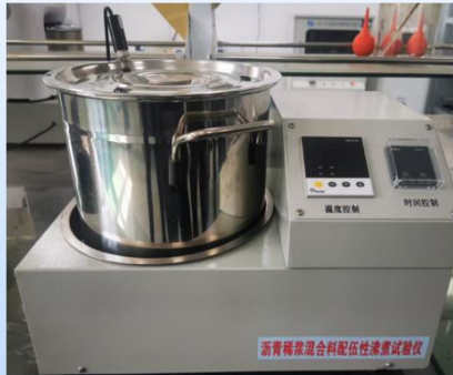
稀浆混合料配伍性煮沸试验仪
