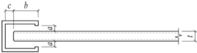
图8 单层玻璃、夹层玻璃面板与型材槽口配合尺寸示意图
